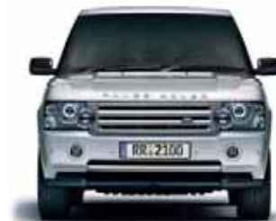
Bodenfreiheit Bei Off-Road-Niveau: 283 mm (bei Standardniveau: 232 mm)
