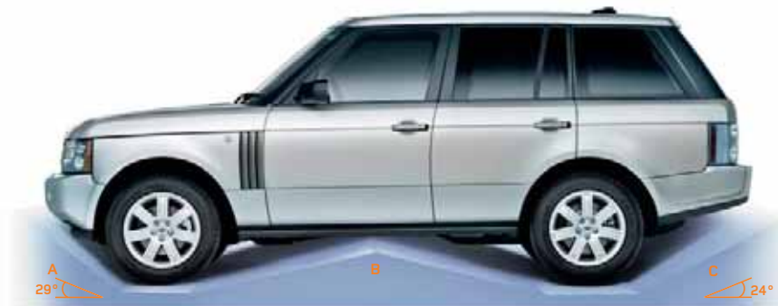
A Böschungswinkel vorn Bei Standardniveau: 29°, bei Off-Road-Niveau: 34° (bis Spoiler)
