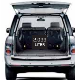
Laderaum Rücksitze umgelegt Höhe: 1.002 mm Breite: 1.124 mm Laderaumbreite zwischen den Radkästen: 1.040 mm Länge: 1.529 mm
